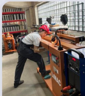
ПРОДОЛЬНАЯ СВАРКА ОГНЕТУШИТЕЛЕЙ
