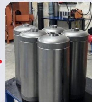
ПОДГОТОВКА ОГНЕТУШИТЕЛЕЙ К СВАРКЕ
